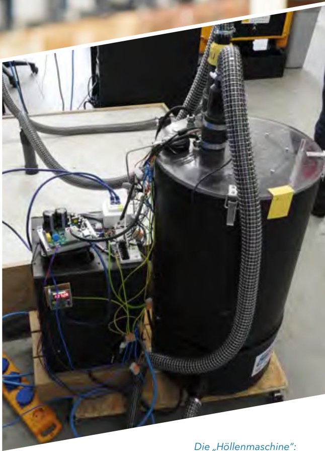
Die „Höllmaschine“: der Prototyp des innovativen Gebäudetrocknungsgeräts Vario II im Testaufbau
